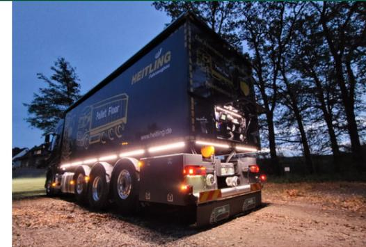
Getreide, Leichtgüter, Agrarprodukte sowie Hackschnitzel und Holzpellets am Zielort sicher und dosiert abladen. Im Vergleich zu einem Kippfahrzeug bietet der Schubboden eine überlegene Standsicherheit. Selbst in abschüssigem Gelände minimiert es Kippgefahren. Auch in niedrigen Gebäuden ist das System uneingeschränkt einsetzbar.
